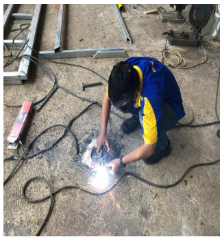
Gambar 2: Pembuatan drum pembakaran limbah
