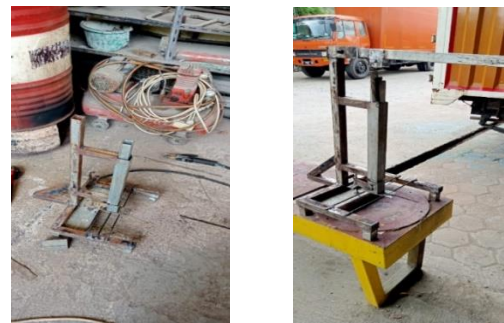
Gambar 7. Assembly dengan welding
