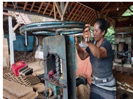
Gambar 2. Proses Pencetakan Genteng Tradisional di Desa Pejaten
